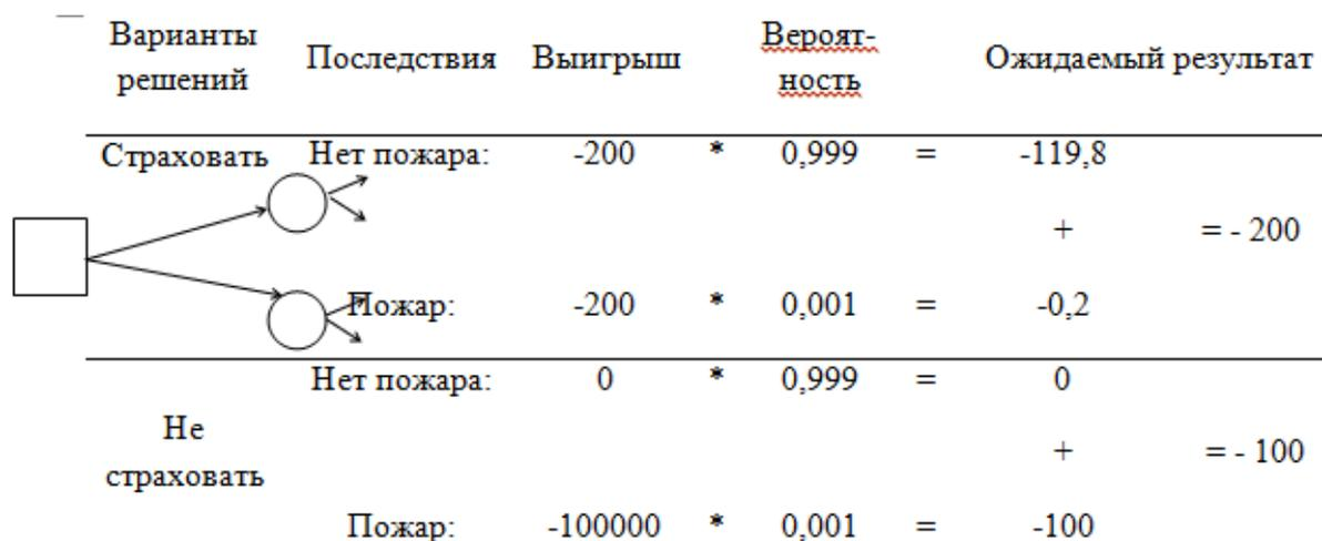
Рисунок 1. Пример дерева решений для страхования здания
