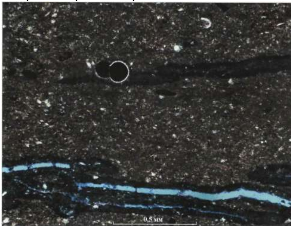
Рис. 1 Фотография шлифа с микротрещинами и ореолами вокруг них
